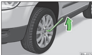
Илл. 158 Замена колеса: откручивание колёсных болтов
