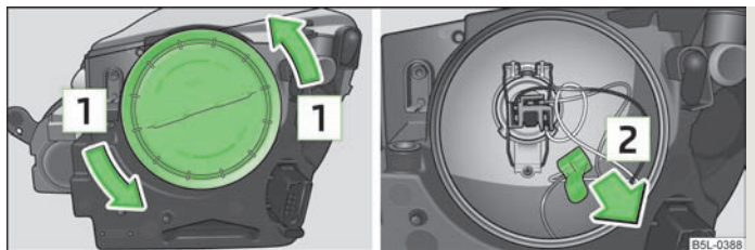
Илл. 170 Снятие резиновой крышки / снятие патрона лампы габаритного огня (галогеновые фары)
