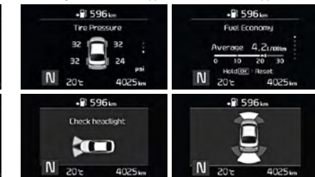
Монохромный ЖК-дисплей TFT 3,5 дюйма
