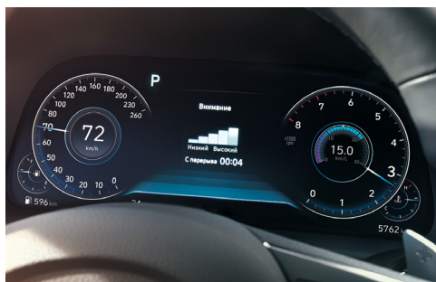
Цифровая приборная панель с HD-дисплеем 12,3 дюйма / Выбор режима движения (Comfort / Smart / Eco / Sport)
