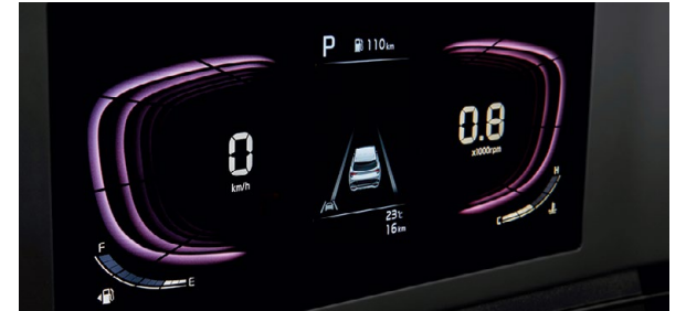
4,2-дюймовый дисплей приборной панели
