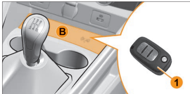
Рис. 3.5.3. Место размещения считывающего устройства
