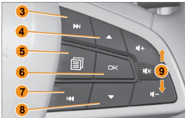
Рис. 4.6.3. Дополнительный блок В управления MMC (в варианном исполнении)
